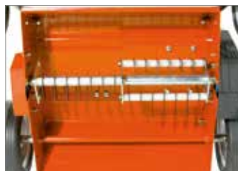
Rotor con 28 cuchillas flotantes montadas sobre rodamientos de bolas y sistema de engrase.
