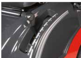
Práctica palanca de regulación de la altura de corte, situada al alcance de la mano y provista de escala graduada para visualizar inmediatamente el nivel seleccionado.
