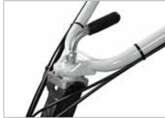
Brazos con regulación vertical y horizontal mediante una cómoda empuñadura situada en el extremo de la columna de dirección.
