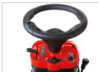
El acoplamiento del embrague electromagnético se realiza de modo rápido y silencioso mediante un cómodo botón situado en el tablero de mandos.
