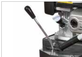
Comando seletor das velocidades com alavanca.
