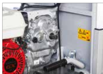
Prise de force indépendante à 2 100 tr/min.
