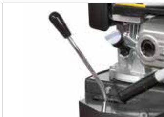
Commande sélecteur des vitesses avec levier.
