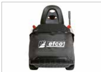
Levier télescopique de vidage du sac proche du poste de conduite, permet de basculer et de vider le sac plein sans effort musculaire et sans tourner le buste.
