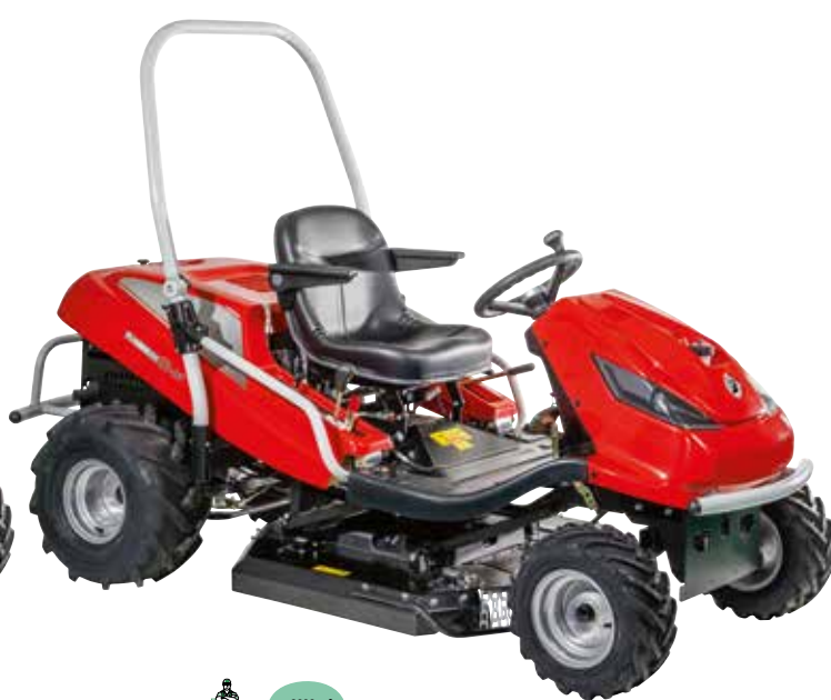
Équipées de série d'une rollbar, de pare-chocs avant et arrière, de protections latérales et de ceintures de sécurité pour une protection complète durant les situations les plus critiques.
