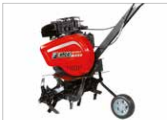
Колесо заднего хода служит для перемещения машины.
